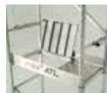
開閉式作業床
